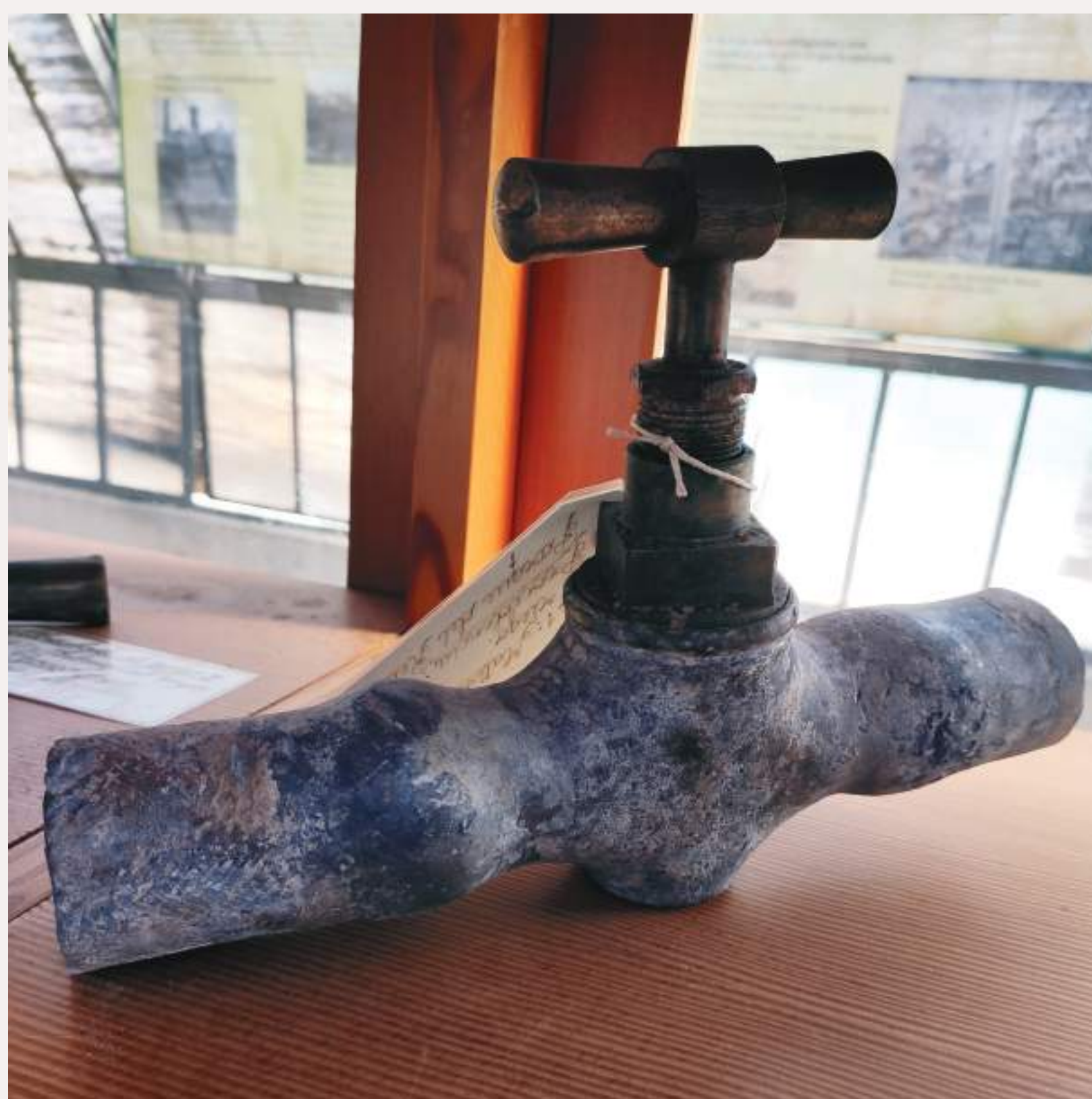
Tubería de plomo con llave de bronce.
